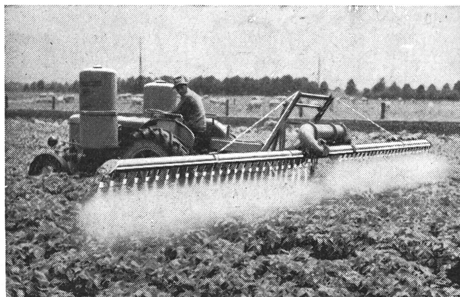
Abb. 12: Nebelblaser mit Querbalken mit 50 Düsen (Arbeitsbreite 8 m)
