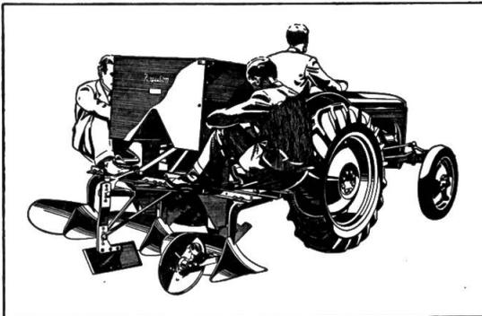
**Querhackgerät** zum Auslichten von Zuckerrübenkulturen, 4- und 6-reihig. Einzel abgefederte Auslichträder mit auswechselbaren Messern.
