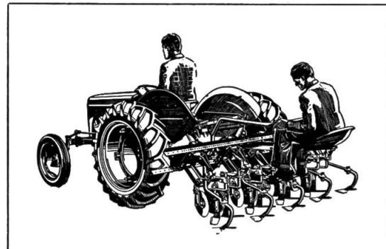
**Hackgerät**, steuerbar, leicht verstellbare Löffel- und Gänsefußscharen und Scheiben, Bedienung mit Feinsteuermann. 4-reihig (speziell für Zuckerrübenbau).
