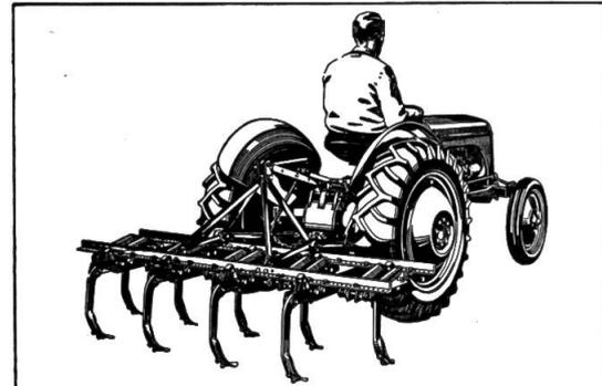
**Kultivator Tiller**, 9 an Spiralfedern aufgehängte Zinken für Arbeit auch in schwersten Böden. Auswechselbare Scharen. Arbeitsbreite 1,86 m, Arbeitstiefe 23 cm.
