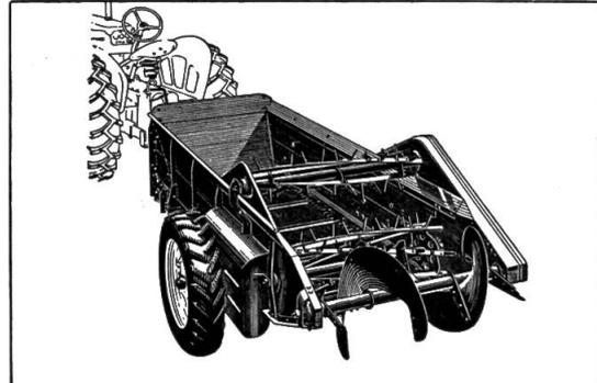
**Mistzetter**: Radantrieb, neuer Streumechanismus, Nutzinhalt 2 m<sup>3</sup>.
