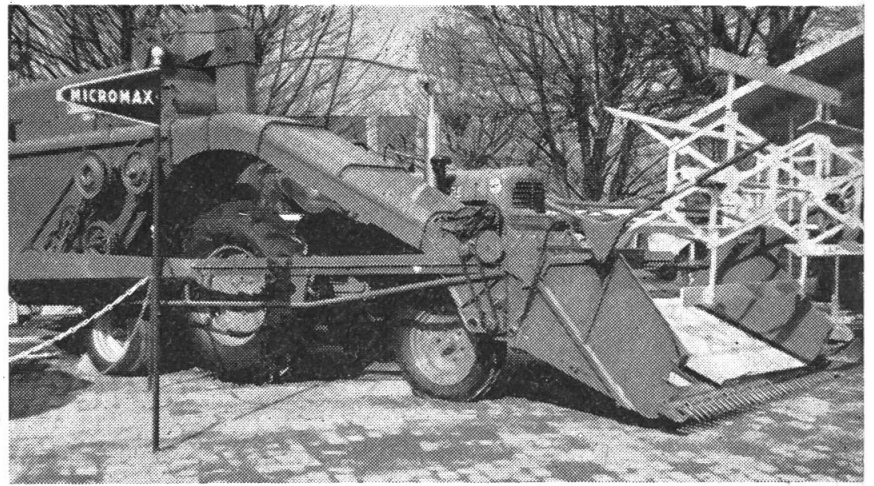
2 Ein um den Traktor gebauter Mähdrescher der französischen Firma Dhotel.
