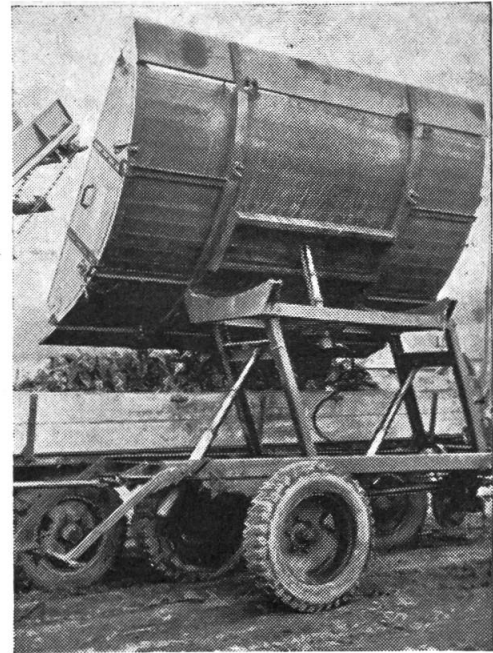
Abb. 11: Die neue Bors-Vorbau-Triebachse kann an jeder normalen Achse vorne oder hinten eingebaut werden.
