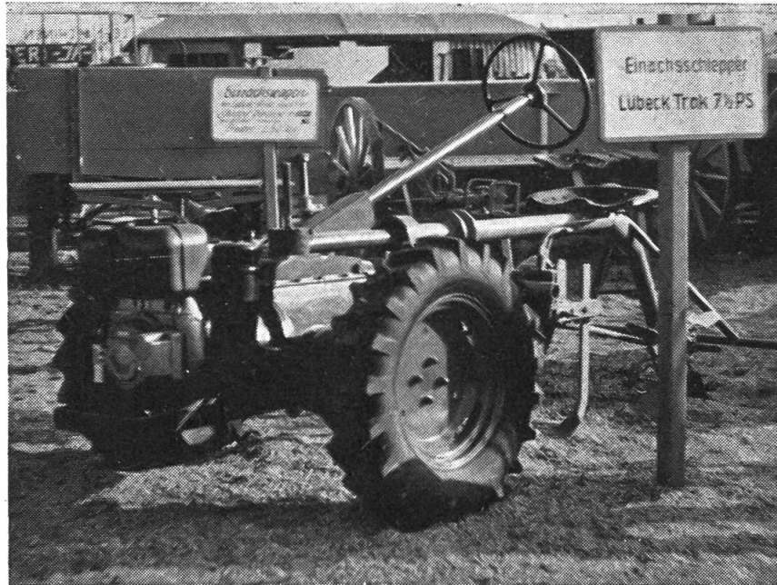
Abb. 16: Der neue Lubeck-Trak, 7,5 PS. Er wird im Gegensatz zu andern Einachsern vom Fahrsitz aus mit Handrad gesteuert. Hersteller: Georg Harder AG., Lübeck.
