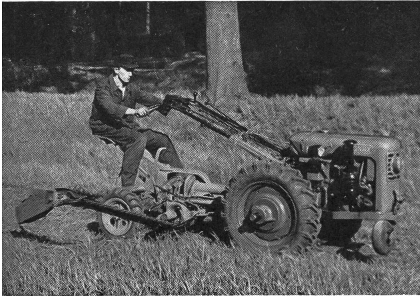
Abb. 17: Monax-Geräteträger mit angebauter Mähmaschine für Zapfwellenantrieb.
