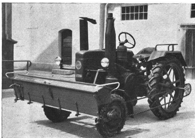
Abb. 3: Düngerstreuer «Rauch» DK 2, frontal am Traktor angebaut.
