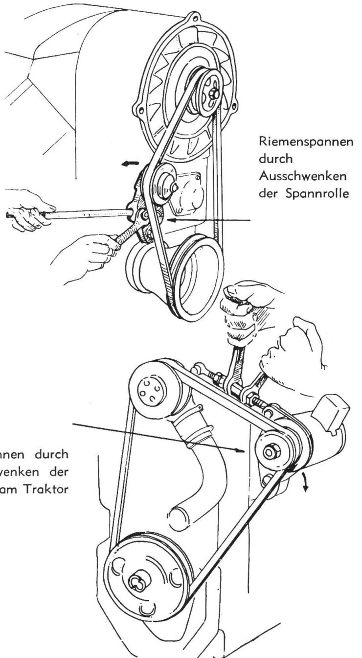
Riemenspannen durch Ausschwenken der Spannrolle
