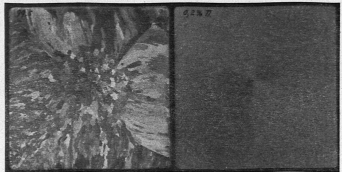
Fig. 4. Stellt den Einfluss von Ti auf die Korngrösse von Rein-Al (99,5%) bei Kokillenguss dar. Links ohne und rechts mit 0,2% Ti-Zusatz. 1/3 nat. Grösse.
