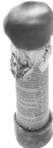
Abb. 11: Die Aluminiumform wird mit Plastilin fixiert.
