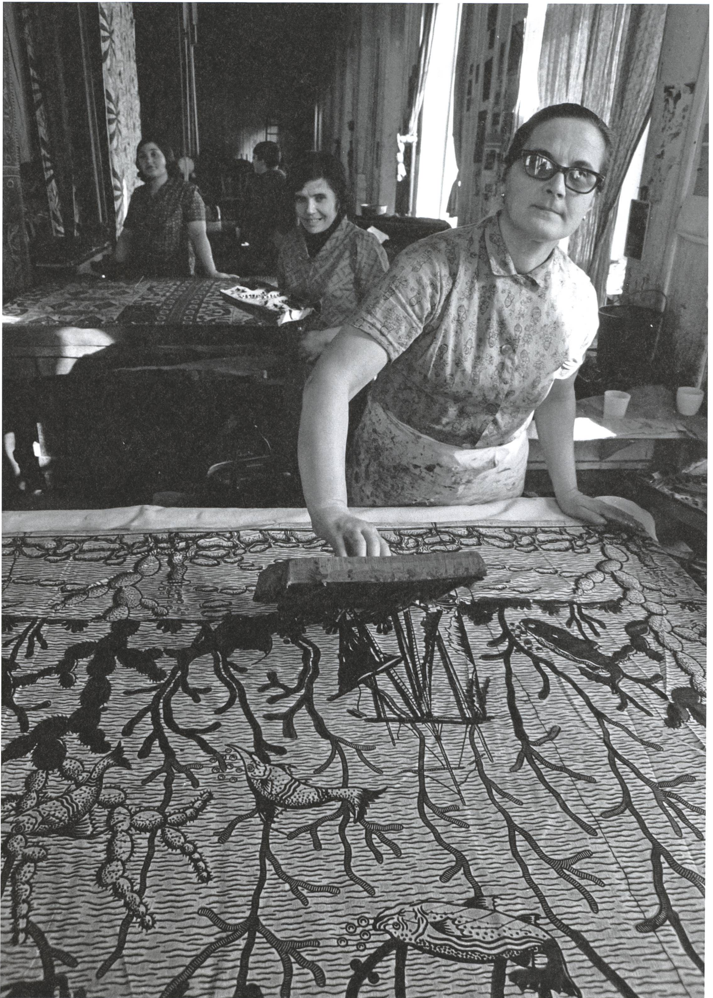
Arbeiterinnen einer Glarner Textilfabrik beim Batikdruck, fotografiert von Hans Witschi / ETH-Bibliothek Zürich / CC BY-SA 4.0.
