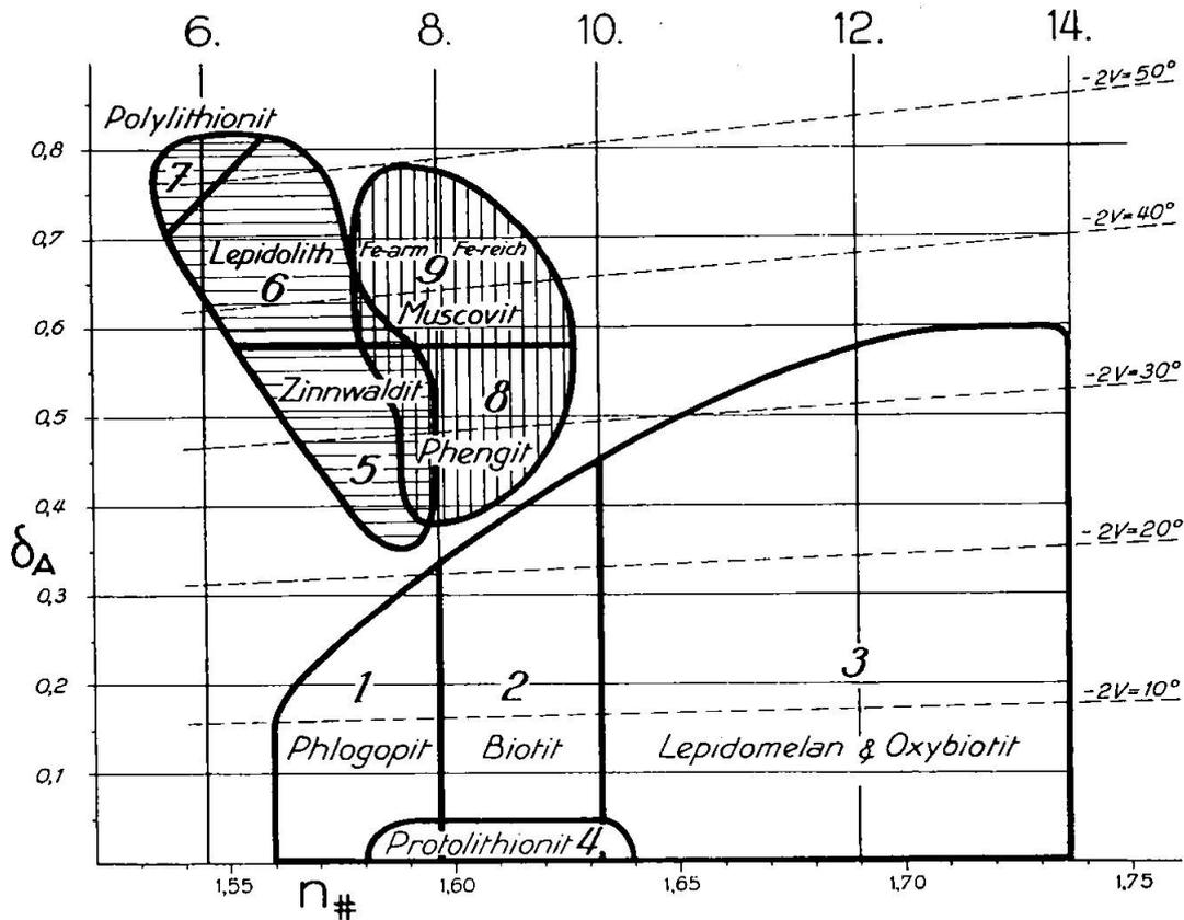
Fig. 1. Beziehungen zwischen den Brechungsindices der Spaltblättchen ( $n_{\parallel}$ ) und der Zentraldistanz der optischen Achsen in Bruchteilen des Radius des Gesichtsfeldes im Konoskop bei Benützung eines Objektivs mit der numerischen Apertur ( $\delta_A$ ).
