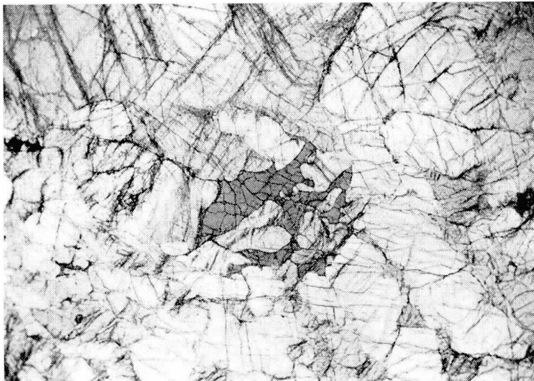
Fig. 3. Nicht metamorpher Lherzolit von Baldissero mit primärem, zwickelfüllendem Spinell. Bildlänge: 10 mm, Nic. //.
