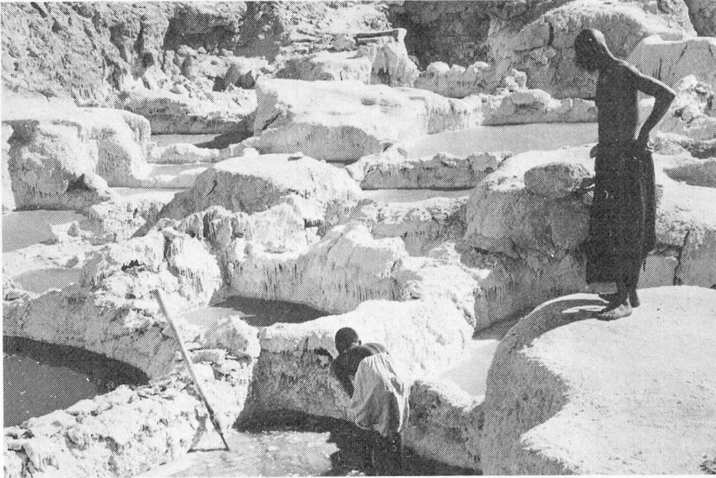
Abb. 4 Blick in eine Saline. Der Stock mit der Metallspitze dient zum Lösen des verkrusteten und hart gewordenen Salzes vom Grund des Beckens.
