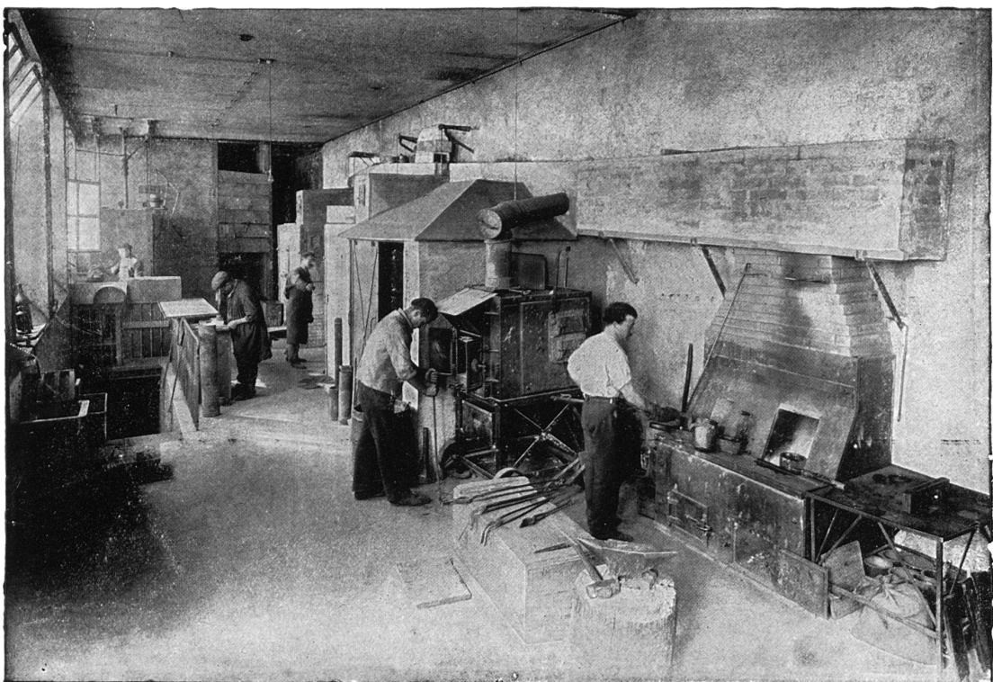
Ateliers de MM. Huguenin frères au Locle (Neuchâtel). Fonderie, trempe et recuite des aciers.
