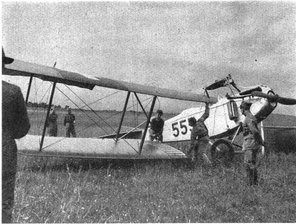
Zweites Tragflächenpaar wird ausgehoben. Démontage de la deuxième paire d'ailes.
