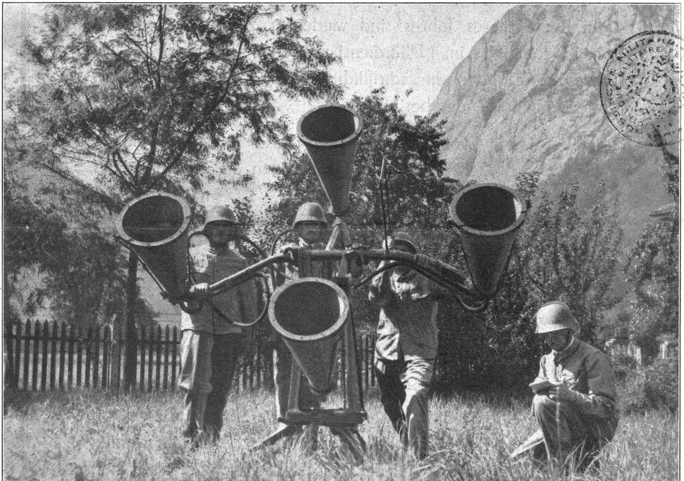
Passiver Luftschutz. — Horchgerät eines schweizerischen Fliegerbeobachtungspostens mit Bedienungsmannschaft Phot. K. Egli, Zürich Protection passive contre les gaz. — Appareil d'écoute d'un poste suisse d'observation aérienne avec équipe de servants
