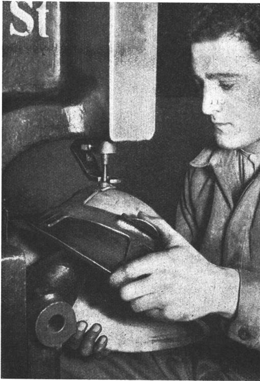
Nach vollendetem Ziehen der Helme werden in erster Linie die Ventilationslöcher eingebohr, wobei eine spezielle Schablone über den Helm gestülpt wird.
