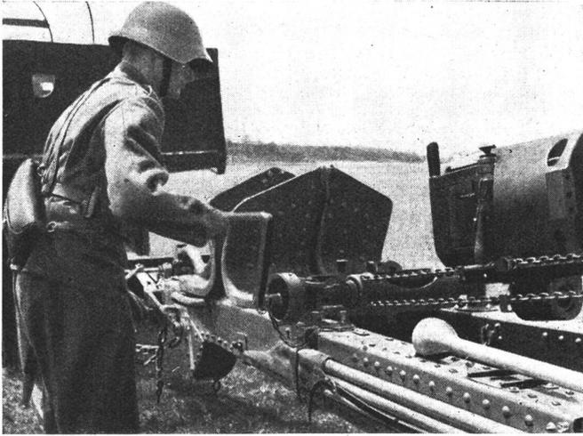
Ebenfalls während des Marsches ist das 4,4 m lange Geschützrohr auf ein hinteres Marschlager zurückgezogen, in das die Winde eingebaut ist, mit welcher das Rohr dann mittels einer Kette in die Schußstellung vorgewunden wird. Die Verbindung des Rohres mit der Preßluftvorholung erfolgt durch eine starke Schraube, deren Führungskanal im Bilde noch rechts unter dem Verschuß sichtbar ist. Hinten auf der Lafette sind während des Marsches die zwei je 50 kg schweren Lafetten-Sporne befestigt.
