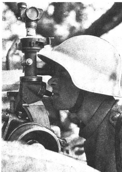
Vom Kommandoposten, der telephonisch mit der Batterie verbunden ist, werden mittels eines Scherenfernrohres die Wirkung des Feuers der eigenen Batterie beobachtet und notwendige Korrekturen durch das Telefon zur Batterie zurückgegeben.
