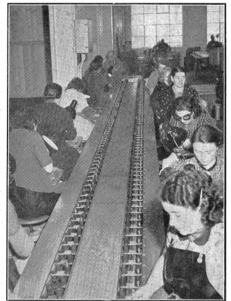
Die Nachkontrolle und das Auspolieren der Geschöckkörper am laufenden Band. Le contrôle et le polissage des obus à la chaîne. Controllo finale e liscio dei corpi dei proiettili alla cinghia scorrevole.
