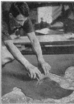
Nach Beendigung des eigentlichen Gerbens werden die Häute unter verschiedenen Malen durch maschinelles und Handstoßen ausgeplättet und gedehnt.
