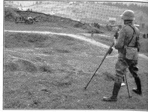
Sofort nach dem Stellungenbezug richtet der Schießoffizier Geschütze mit Hilfe des Batterie-Instrumentes auf einen Zielstellungspunkt ein. (VI Br 4174.) Aussitôt après la prise de position, l'officier de tir met les pièces en direction, au moyen de l'instrument de btr., sur l'azimut de surveillance. Quando i pezzi sono in posizione, l'ufficiale di tiro provvede subito al loro puntamento, servendosi degli speciali istrumenti di batteria.
