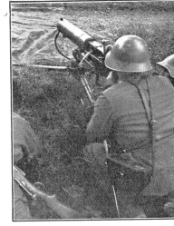
Rechts: Der Stellschieber des Lmg. soll nur beim Bergabwärts- und Blindschießen auf Nachzündung gestellt sein, in allen andern Fällen führt Nachzündung zu Ladestörungen durch Stauchungen an den Patronen (siehe Pfeil). (A Er 434.)
