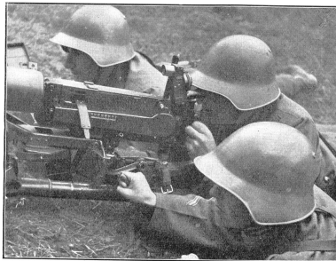
Ist bei Flächenfeuer über 8% Tiefenfeuer abzugeben, so hat der Schießende das Höhenrad des Schraubenziehers in das Rad einzusetzen. (A Er 437.) Le tir sur zone, il faut tirer en profondeur de plus de 8%, l'aide de tir est alors à utiliser le volant d'élevation. A cet effet, on insère le tournevis dans le volant. Se il fuoco di zona comprende oltre l'8% di fuoco in profondità, il volante sarà più efficacemente azionato dall'aiuto-tiratore, e precisamente con l'aiuto di un cacciavite.
