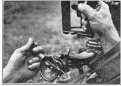
Sowohl beim Tiefenfeuer auf nahe Ziele wie auch im Flächenfeuer (gleichzeitiges Breiten- und Tiefenfeuer) wird zum raschen Drehen des Höhenrichtrades vorteilhaft der Schraubenzieher verwendet. (A Er 444.)
