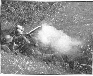
Zur Vermeidung der Dampfentwicklung beim Mg. genügt es nicht, nur das Ende des Dampfeschlauchs in den Boden zu stecken, sondern ..... (siehe nächstes Bild)
