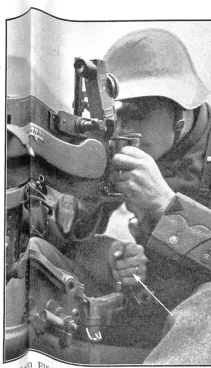
Ist bei Flächenfeuer über 8% Tiefenfeuer abzugeben, so hat der Schießende das Höhenrad des Schraubenziehers in das Rad einzusetzen. (A Er 437.) Le tir sur zone, il faut tirer en profondeur de plus de 8%, l'aide de tir est alors à utiliser le volant d'élevation. A cet effet, on insère le tournevis dans le volant. Se il fuoco di zona comprende oltre l'8% di fuoco in profondità, il volante sarà più efficacemente azionato dall'aiuto-tiratore, e precisamente con l'aiuto di un cacciavite.
