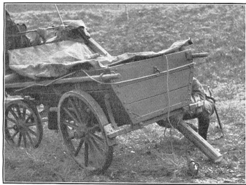
Anfertigung eines Schleifbaumes. Unbrauchbar gewordene Räder sind, wenn Reserverräder fehlen, durch Schleifbäume zu ersetzen, die wegen des Rechtsfahrens stets hinten rechts anzubringen sind. (Zensur-Nr. A N 0492.)
