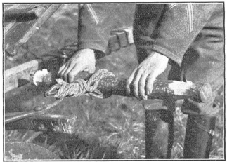
Gebrochene Waagscheite sind durch zurechtgeschützte Holzsparren zu ersetzen, die durch Tragbündel an der Waage festgemacht werden. (A N 0484.)
