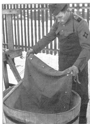
Die zu imprägnierenden Zelte sollen möglichst trocken sein, damit sie sich gleichmäßig mit der Flotte vollsaugen. Sie werden in das Imprägnierungsbad eingelegt und sind 2 Stunden darin zu lassen. (A Ev 0517.)
