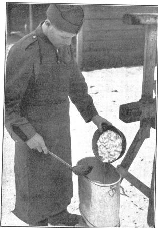
Für das Imprägnieren von Zelteinheiten liefern die Nachschub-Zentralämter eine spezielle Imprägniermasse, von welcher pro Zelt je 40 g in 100 cm<sup>3</sup> 50 ° C heißen Wasser aufzulösen sind. (Zentral-Ar-Mr. A Ev 0522.)
