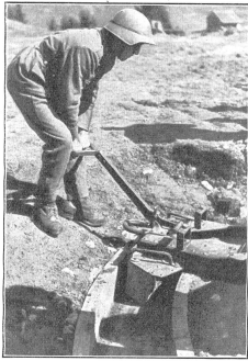
Der Hilfsrichter gibt dem Geschütz durch Schwenken der Lafette in der Führungsschiene die grobe Richtung.
