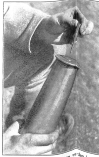
Für die ersten Schießübungen werden Leuchtspur-Gewehrpatronen verwendet, die vermittlels einer besondern Ladungsvorrichtung in das Geschütz eingeführt werden.
