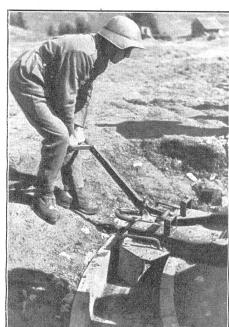
Eine am Richtaufsatz angebrachte gepolsterte Kopfkrone erleichtert dem Richtkrieger das unterbrochene Richen des Geschützes mit dem Panoramafenster. Besondere Vorrichtungen ermöglichen das Einstellen von Distanz und Seite durch den Vordermann.
