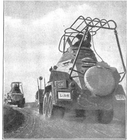
Bild 2. Dreischneige Panzer-Spähwagen mit ihrem typischen Antennenmast für den Funkverkehr. Fig. 2. Autos blindées d'exploration à 6 roues, avec antenne pour radio. Fig. 2. Carri armati da ricognizione con le loro tipiche antenne per la trasmissione radio.
