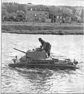
Bild 5. Wasserdichter Einbau des Motors gestattet den Panzer-Kampfwagen auch das Durchfahren von Wasserläufen bei genügend festem Flußbett. Fig. 5. Grâce à l'étanchéité absolue de son moteur, le tank peut traverser aisément des cours d'eau peu profonds, à la condition que le lit de ceux-ci soit suffisamment ferme.
