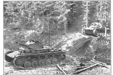
Bild 4. Patrouille mittlerer Panzer-Kampfwagen (5 Laufräder) beim Vorbrechen aus einem Walde. (Bewaffnung 1—2 Mg, 1 Panzerkanone 20 mm). Fig. 4. Patrouille de tanks moyens au cœur d'une forêt (armement: 1—2 mitr., 1 canon de 20 mm). Fig. 4. Pattuglia di carri armati medi (5 ruote) che sbucano da una foresta (armamento: 1—2 Mitr.; 1 cannone anticarro da 20 mm).
