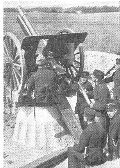
Primitive Fliegerabwehr aus dem Jahre 1916: 7,5-cm-Feldgeschütz, auf Betonsockel und Drehscheibe montiert. — DCA primitive de l'année 1916: canon de campagne 7,5 cm., monté sur socle de béton et plaque tournante. — Difesa contraerea primitiva del 1916: cannone da camp. da 7,5 cm. montato su basamento di cemento armato e su braccio girevole.
