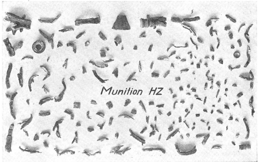
Splitterwirkung einer 20-mm-Flab-Hochbrisanzgranate mit Doppelzünder und Leuchtspur.
