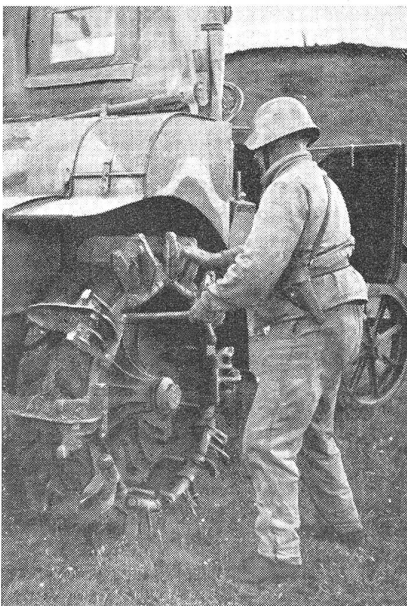
Umstellen der Radschaukeln eines Artillerietraktors für eine Geländefahrt. (Z.-Nr. VI Schr 9816.)
