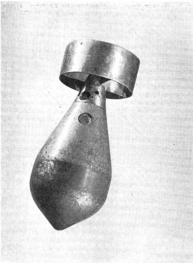
Tropfenförmige Elektron-Thermit-Brandbombe, ein Modell, wie es heute wegen der großen Raumbeanspruchung kaum mehr zur Verwendung gelangt. Gewicht ca. 1,8 kg, Länge 22 cm.
