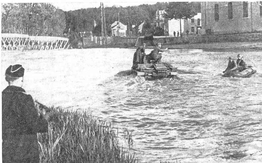
Schon die gewöhnlichen Panzerwagen besitzen eine «Wat-Fähigkeit», die ihnen das Durchqueren von Wasserläufen gestattet.
