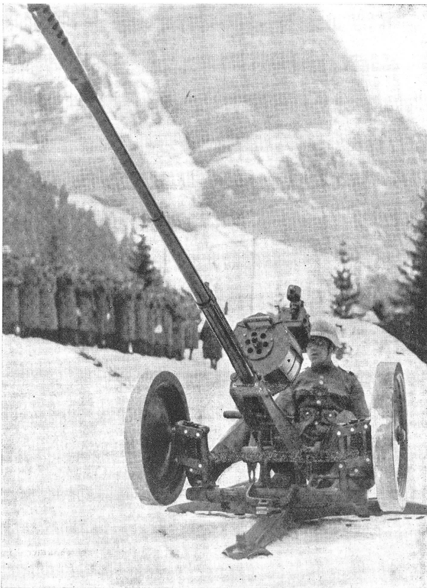
Die Flab-Kanone 43 in Feuerstellung gegen Luftziele. Vorne an der Mündung erkennt man die Schußbremse. Vor dem Trommelmagazin ist über dem Rohr das Gasdruckrohr montiert. Hinter der Trommel wird das Zielgerät sichtbar, durch das der Schütze den Flieger direkt anvisiert. Der ganze Schlitten mitsamt dem Fahrgestell läßt sich um 360 Grad drehen. Mit dem linken Pedal löst der Kanonier den Schuß aus. (N/V 13942.)
