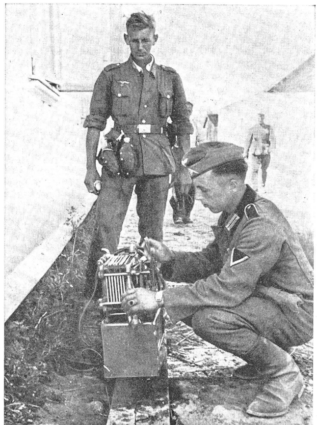
Tragbares Filtriergerät der deutschen Armee, mit dem jedes Grundwasser zum Trinken zubereitet werden kann.
