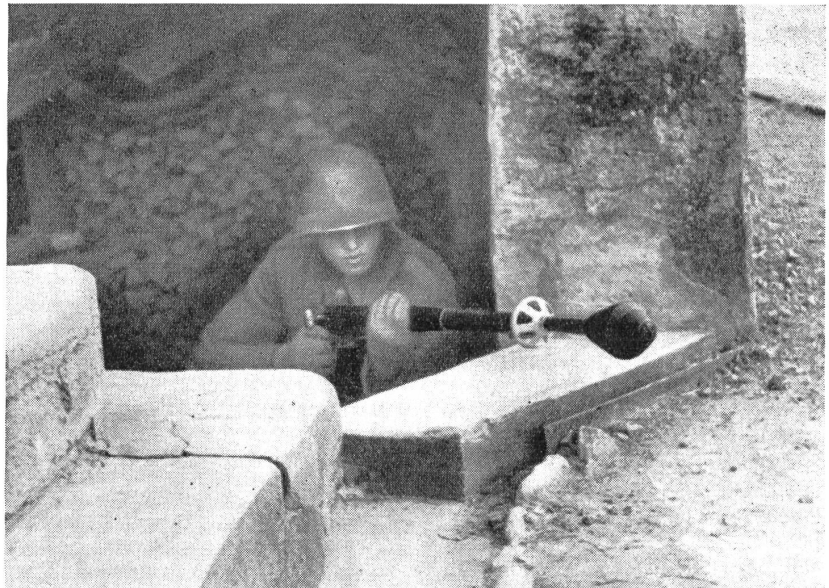
Der Schütze mit der Panzerwurfgranate in einem Kellerhals in Stellung. Die linke Hand hält das Gewehr fest, während die Rechte den Schuß auslöst. (V N 17295.)
