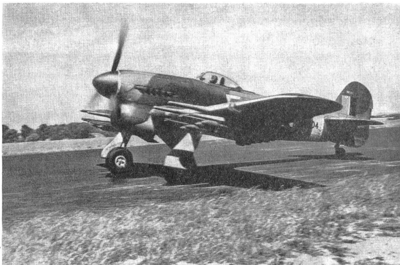
Raketenfeuernder HAWKER-TYPHOON-Jäger auf einem Startplatz der nordfranzösischen Küste. (In und unter den Flügeln angeordnet sind die Flügelkanonen und die Raketen-Geschosse.)
