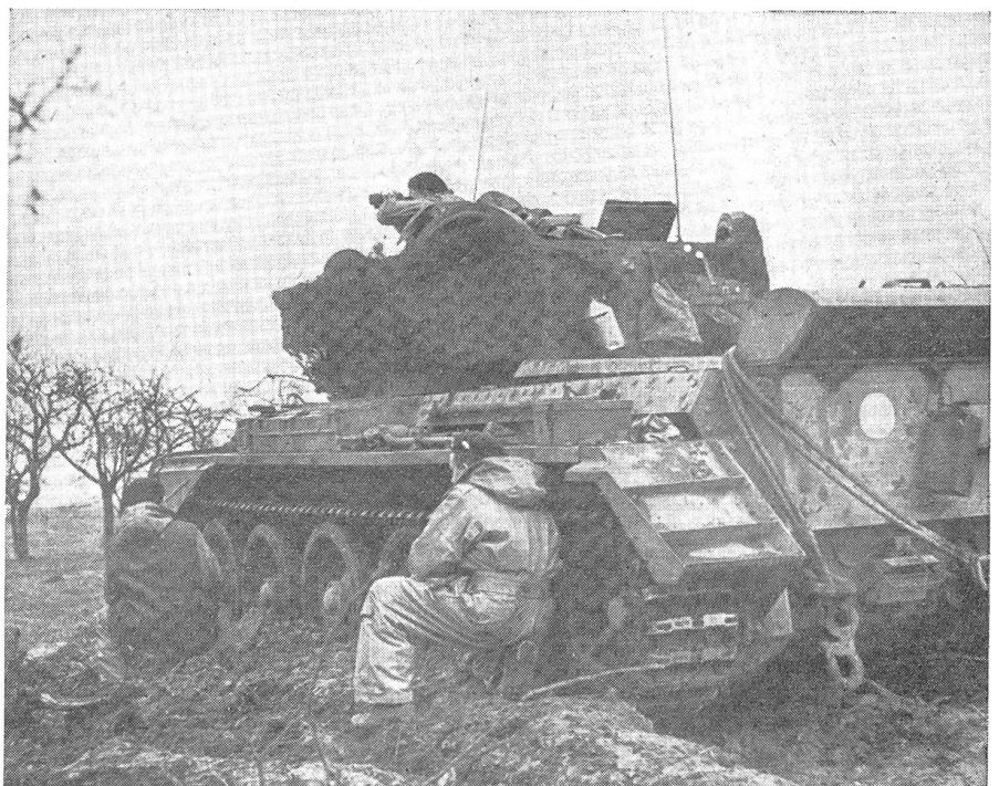
«Crusader»-Panzerkampfwagen als Beobachtungsposten. Man beachte die Ersatzlaufrollen, die rings um den Geschützturm befestigt sind.
