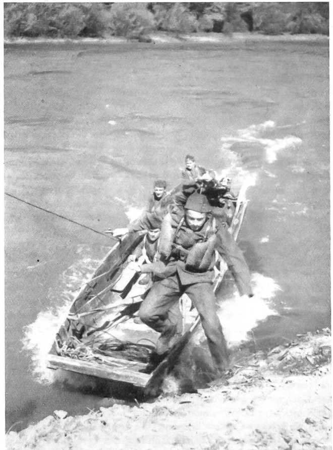
Uebersetzen von Truppen in Schlauch-Uebersetz- und Sturmbooten. Die Sturmbooten sind mit einem 4-Zylinder-Kovats-Außenbordmotor (35 PS) ausgerüstet. (ATP Bilderdienst Zürich)
