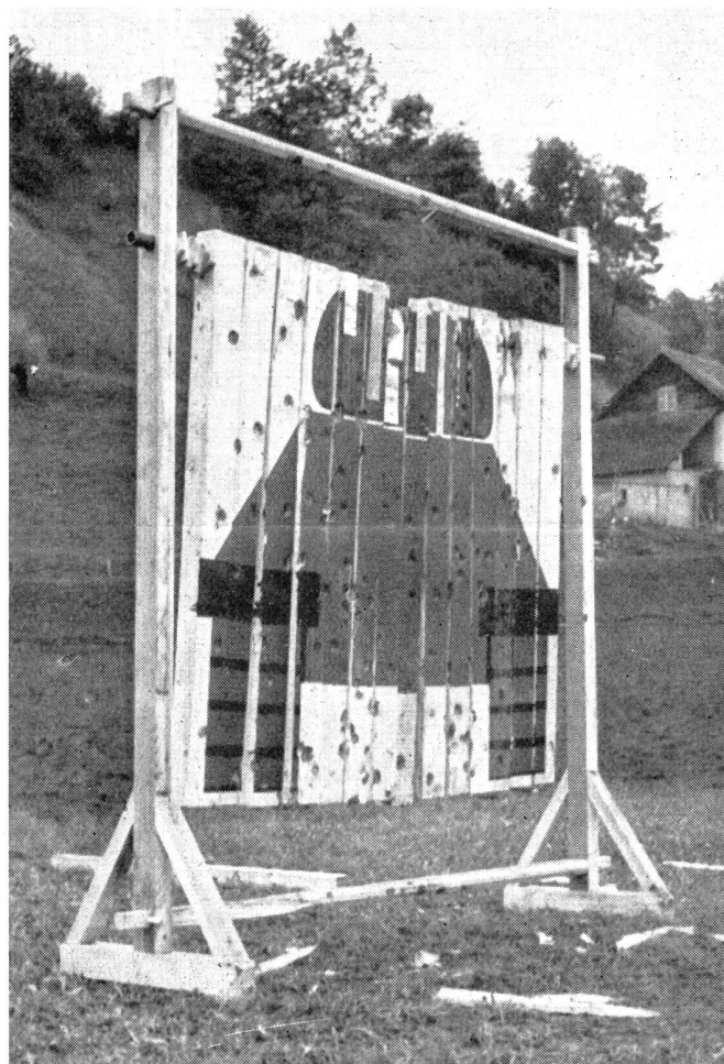
14 dicke Tannenbalken, beweglich aufgehängt, bilden die Grundlage zur PZW-Scheibe. Ueber 150 Einschläge weist diese Scheibe schon auf.
