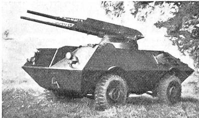
Panzerwerfer mit automatischem Raketenwerfer
