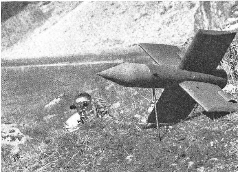
*Die Moskito in Schußstellung. Unser Bild zeigt die abschußbereite Rakete, die von einem Schützen (Hintergrund) über ein Drahtkabel, welches sich beim Abschuß absplitt, bis ins Ziel gesteuert werden kann.*
