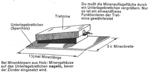
Du mußt die Minauflagefläche durch ein Unterlagebrettchen vergrößern. Nur so ist ein einwandfreies Funktionieren der Tretmine gewährleistet
