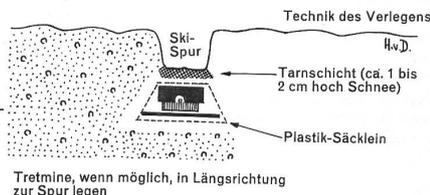
Tretmine, wenn möglich, in Längsrichtung zur Spur legen
