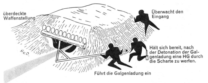
Überdeckte Waffenstellung nach dem Beschuß! Beachte die Wirkung des Vorbereitungsfeuers. Rundholz der Überdeckung verschoben und durcheinandergeworfen. Scharte durch Erde teilweise verschüttet.
