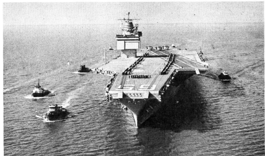
Für die Bedienung der vier Katapulte stehen vier Aufzüge zur Verfügung, die innerhalb von Sekunden die Flugzeuge aus dem Hangardeck auf das Flugdeck bringen (vorne). Rechts hinten: Der Kommandoturm mit seinem Gehirn, das das größte und modernste je auf einem Schiff erstellte Zentrum elektrischer und elektronischer Einrichtungen besitzt.
