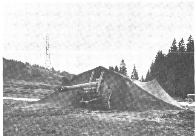
15 cm Haubitze (Sch.Hb.42) Waffengewicht: ca. 6500 kg Transport: Motorzug mit Lastwagen (Geländewagen)
