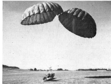
1 Der Abwurf des Kleinfahrzeuges A.S. 24, das nur 220 kg wiegt, erfolgt an zwei normalen Fallschirmen. Es kann von zwei Mann innert einer Minute einsatzbereit gemacht werden.
