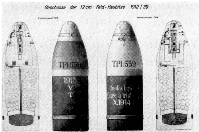
Hier handelt es sich um eine Weiterentwicklung der Munition für die Feld-Haubitze vom Kaliber 12 cm.
