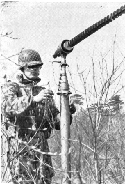
Richtfunkgerät mit «Zigarrenantenne»
