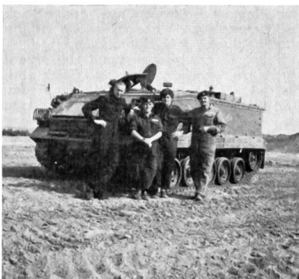
Der englische Schützenpanzer von der Seite her gesehen. Auffallend ist der niedere Bau und die Ähnlichkeit mit dem amerikanischen M-113, von denen die Schweizer Armee 560 Stück erworben hat.
