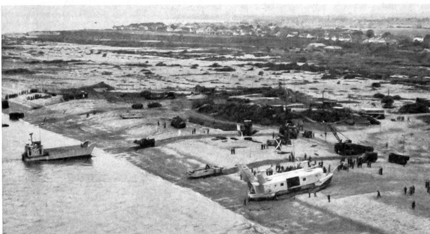
Das SR. N 3 während der militärischen Erprobung in Südengland. Der große Vorteil der Schwebefahrzeuge gegenüber herkömmlichen Landebooten ist auf diesem Bild augenfällig ersichtlich.
