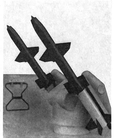
Sechs Kreuzer der amerikanischen Marine sind mit dem Langstrecken-Schiff-Luftlenkwerkssystem Talos RIM 8 ausgerüstet. Hauptantrieben durch ein Staustrahltriebwerk erreicht dieser Flugkörper eine Geschwindigkeit von Mach 2,5, eine Einsatzhöhe von 27 000 m und eine Reichweite von mehr als 120 km. Je nach der zu lösenden Aufgabe ist die Talos-Rakete mit einem Atom- oder konventionellen Sprengkopf bestückt. Dank ihrem differenzierten Führungssystem kann die RIM 8 auch feindliche Schiffe bekämpfen.
